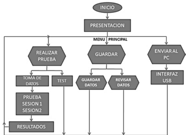
Figura 2. Diagrama de flujo del software del microcontrolador
